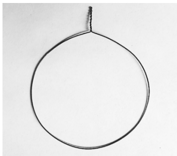
Рис. 1. Фотография резонансного кольца – элемента метаматериала
